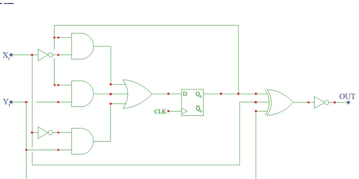
Chiaramente per far funzionare questa macchina occorre che lo stato iniziale  $Q_0$  sia impostato a 0 perché all'avvio della macchina il prestito è nullo.
