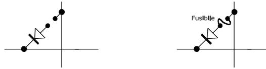
**Figura A.36** Schematizzazione della modalità di interconnessione tra righe e colonne per le ROM (a sinistra) e per le PROM (a destra).
