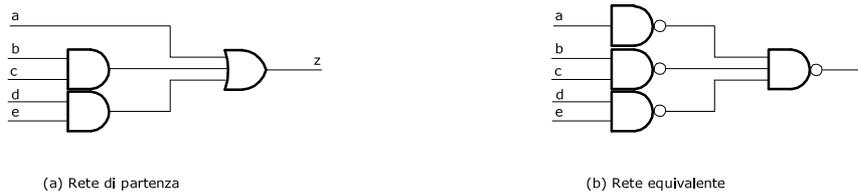
**Figura A.14** Passaggio da rete SP ( $z = a + bc + de$ ) a rete NAND ( $z = \overline{\overline{a}(b|c)(d|e)}$ ). Il passaggio richiede solo la sostituzione di porte AND e OR con porte NAND.
