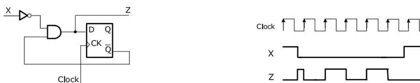
**Figura A.63** Rete secondo il modello di Mealy e possibile sequenza temporale. Si noti che appena  $x$  passa a 0 la rete asserisce l'uscita  $z$ . Ma l'uscita, sul primo clock che campiona  $x$  a 0, durerà normalmente meno di un periodo; in media metà periodo.
