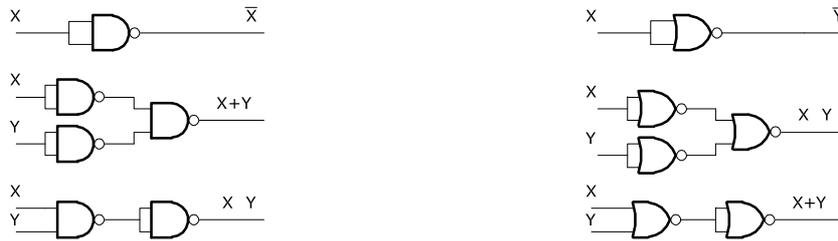
**Figura A.13** Costruzione delle operazioni di NOT, OR e AND dalle porte NAND e NOR.
