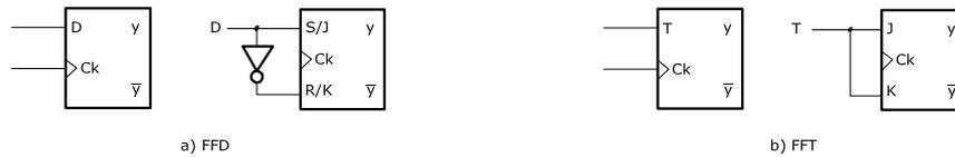
**Figura A.54** Schemi convenzionali dei flip-flop FFD e FFT. Modo in ci vengono ottenuti da FFSR/FFJK o da FFJK rispettivamente.
