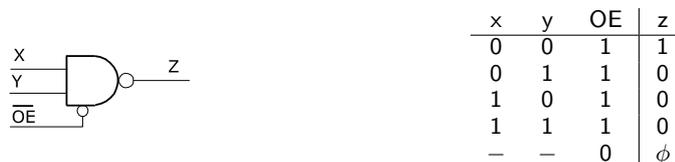
**Figura A.24** Simbolo logico e tabella di verità di una porta NAND con uscita in terzo stato. Il simbolo  $\phi$  corrisponde al terzo stato di alta impedenza.
