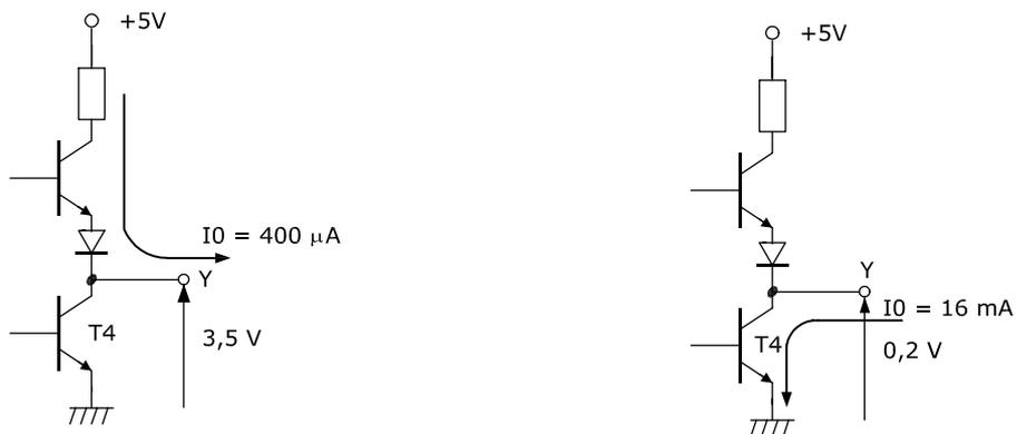
**Figura A.21** Correnti massime (garantite) in uscita nello stato logico 1 e nello stato logico 0 di una porta TTL. In stato alto il transistor T4 è interdetto e la corrente fluisce da  $V_{cc}$  (+5 V) verso gli ingressi collegati a valle (è garantito che la porta eroghi fino a  $400 \mu\text{A}$ ); in stato basso la corrente fluisce dagli ingressi collegati a valle verso massa attraverso il transistor T4 in saturazione (è garantito un assorbimento fino a  $16 \text{ mA}$ ).
