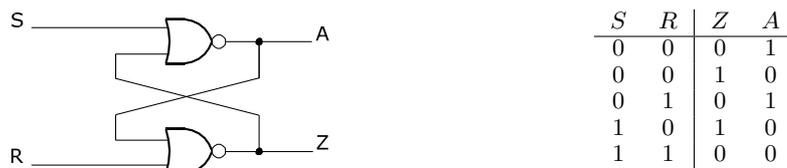
**Figura A.43** Il Latch di NOR e relative relazioni di ingresso/uscita. Il termine anglosassone *latch* significa lucchetto, chiavistello ed esprime, in modo figurato, il comportamento della rete.
