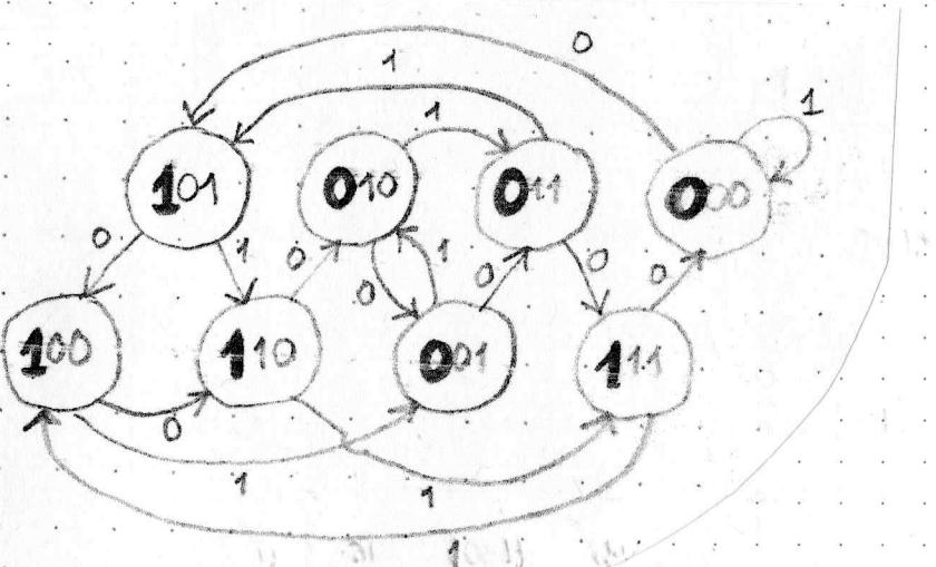
La macchina è inizializzata a  $\emptyset$ ; con uscita  $Q_2 = 0$ . La sequenza di uscita veloce è  $0001100110011000001111$
