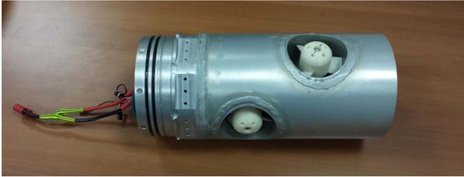
Fig. 5. Thruster module
